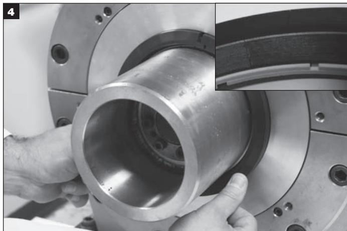
Applicare la forza necessaria per premere la tenuta in modo uniforme nella sua sede. Iniziare premendo le giunzioni verso la posizione delle ore sei.
